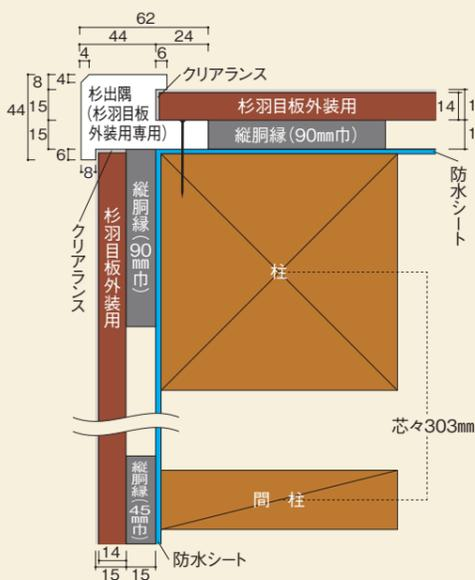
※杉羽目板外装用施工時には必ず水切りを使用してください。
